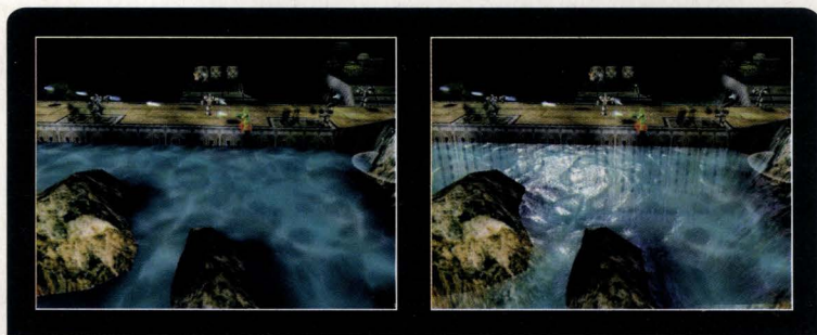
Bump-mapping u hry Expendable . Na prvním obrázku je bump-mapping na povrchu vodní hladiny vypnutý, na druhém je zapnutý.
